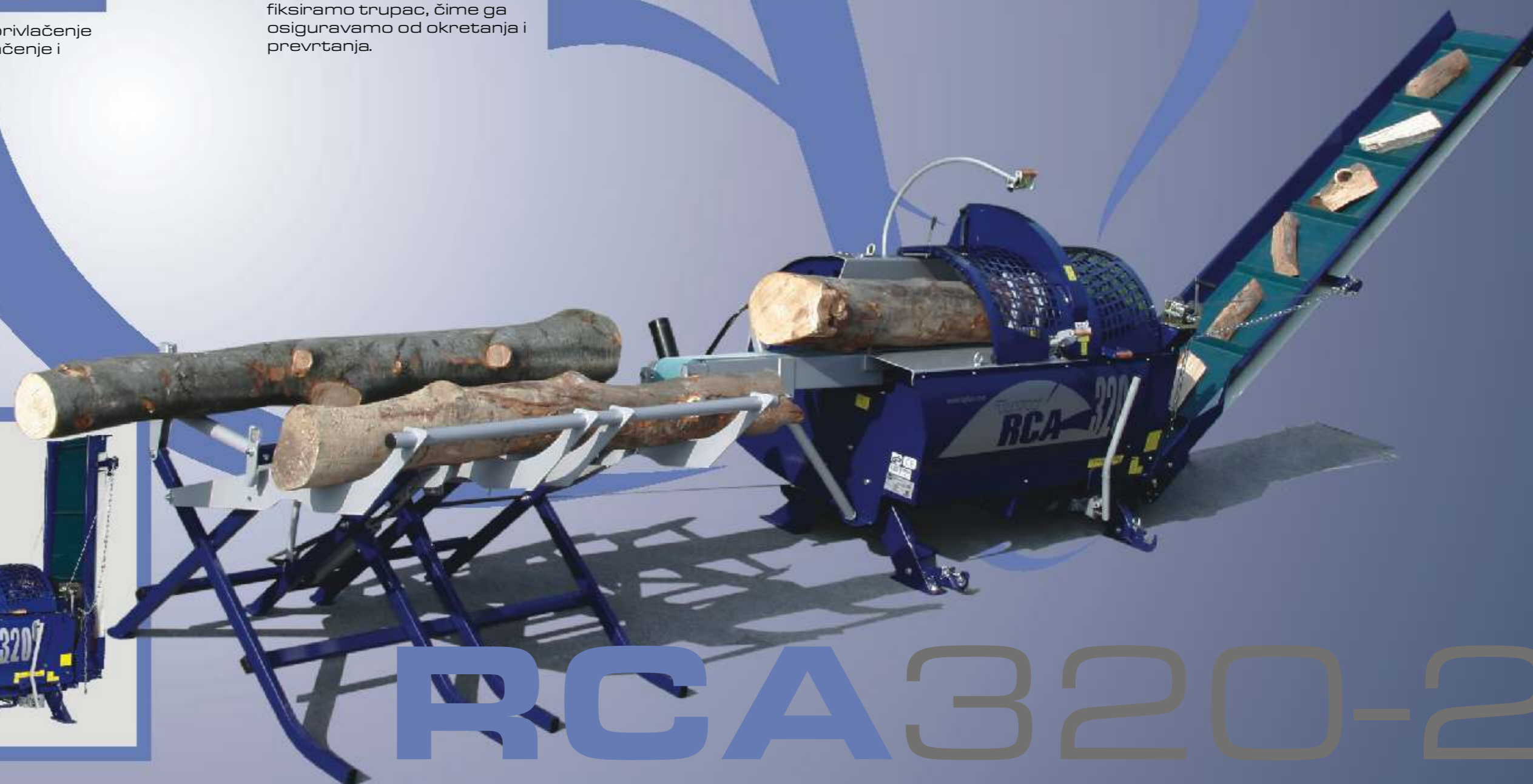
RCA 320-2 ima inovativan graničnik dužine, koji omogućava podešavanje dužine od 25 do 50 cm po 5 cm. Rezanje sa lančanom testerom je brzo i sigurno, a održavanje vrlo je jednostavno.
